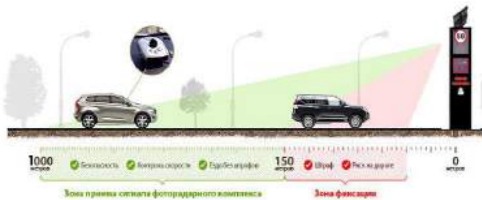
Рис 2. Схема обнаружение движущих объектов.
