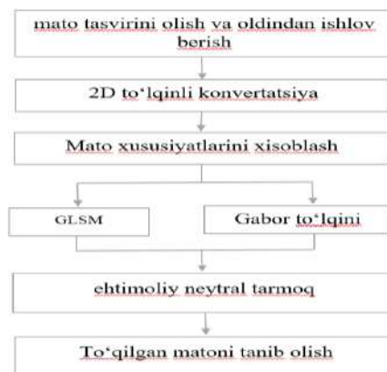
1-rasm: Mato sxemasida tasvirni aniqlashning oqim sxemasi
